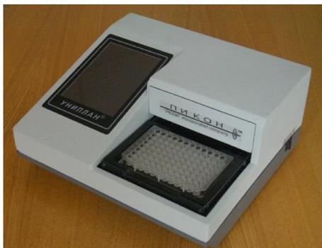
Прибор предназначен для измерения оптической плотности (концентрации) проб в *одноволновом* и *двухволновом* автоматических режимах, в стандартном планшете из 96 микрокувет.
